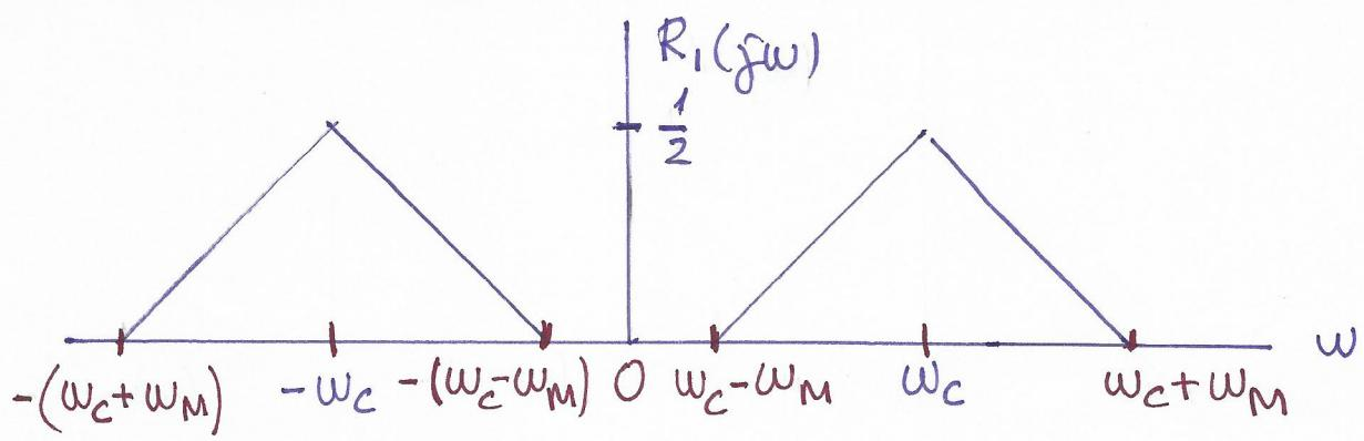
Hacemos pasar la señal por un filtro paso bajo de frecuencia de corte  $\omega_1$ , y así obtenemos  $R_2(j\omega)$
