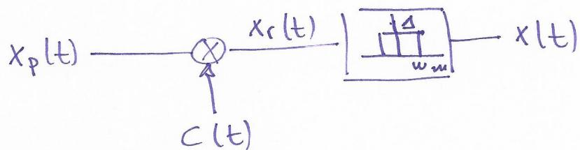
c) Obtener un sistema que permite recuperar la señal de entrada a partir de  $y(t)$
