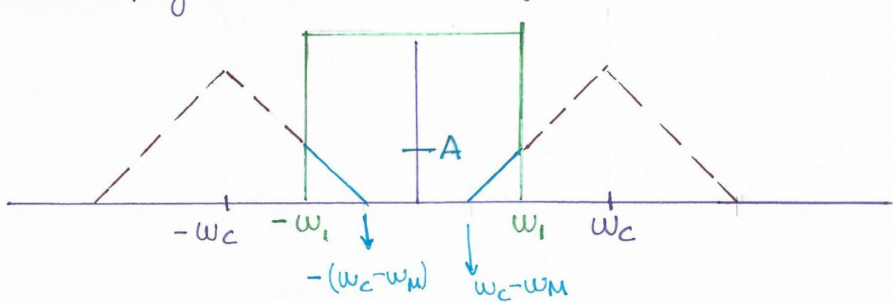
El espectro  $R_2(j\omega)$  sera  $R_1(j\omega) \cdot H(j\omega)$
