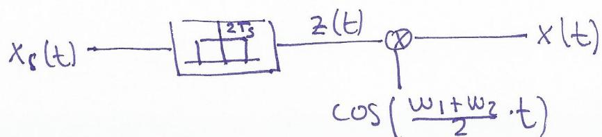
PROBLEMA 4. Mediante la conexión de dos filtros pasa-bajo y de un oscilador de frecuencia  $\omega_0$  se puede sintetizar un filtro, tal y como se describe a continuación:
